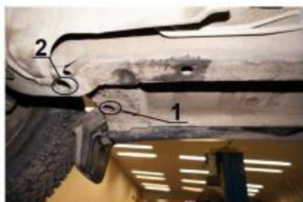
Рис.2 Место установки переднего кронштейна
