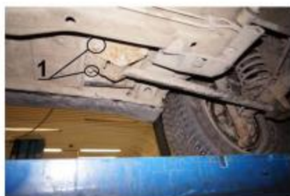
Рис.3 Место установки заднего кронштейна
