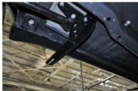
Рис.5 Установка заднего кронштейна
